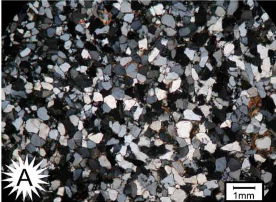
Fig. 5.6: Imagen de lámina delgada de la Formación Huergas. El R_s calculado para esta muestra es 1,1 por el método R_f/\emptyset y 1,23 por el método de Fry.
